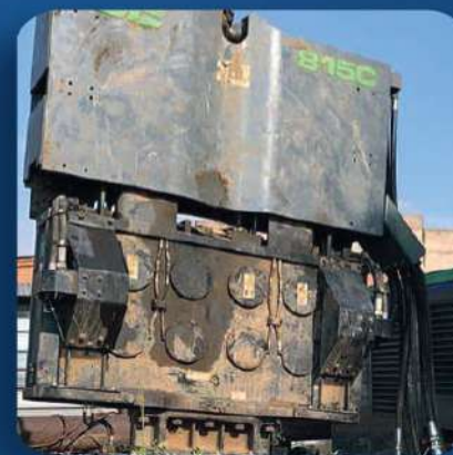
● Вибропогружатель ICE 815C Общий вес 8,5 т Максимальная частота 1570 кг/м
