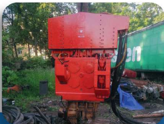
● Вибропогружатель MULLER MS-16HFV Общий вес 4,4 т Максимальная частота 3000 кг/м
