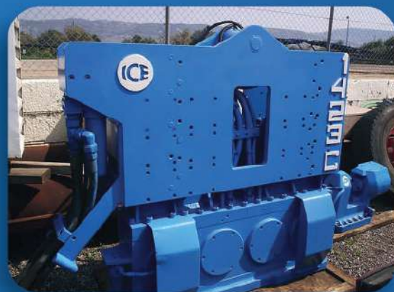
● Вибропогружатель ICE 1423C Общий вес 4 т Максимальная частота 2300 кг/м
