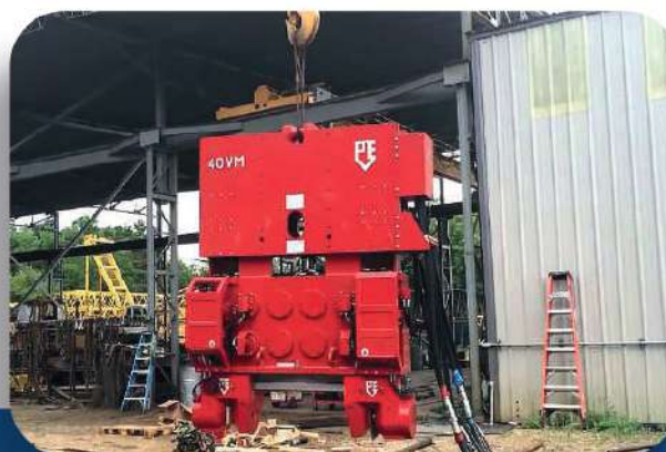
● Вибропогружатель PVE 40 VM Общий вес 7,8 т Максимальная частота 2000 кг/м
